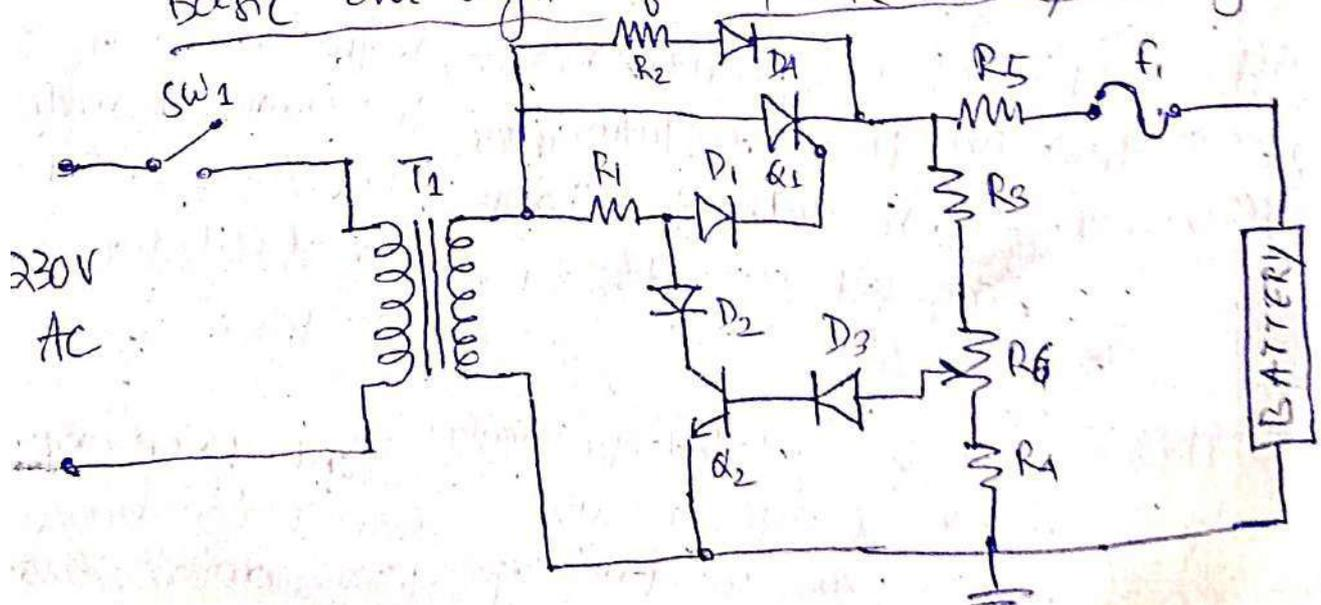
$R_1 \rightarrow 330 \Omega$ ,  $R_2 \rightarrow 22 \Omega$ ,  $R_3 \rightarrow 820 \Omega$ ,  $R_4 \rightarrow 100 \Omega$ ,  $R_5 \rightarrow 1 \Omega$ ,
